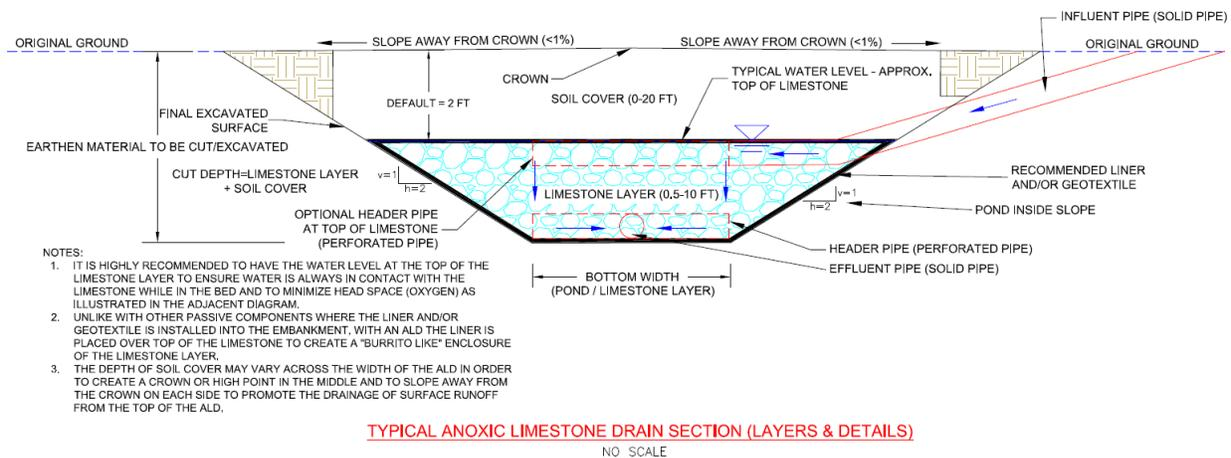
**TYPICAL ANOXIC LIMESTONE DRAIN SECTION (LAYERS & DETAILS)**
