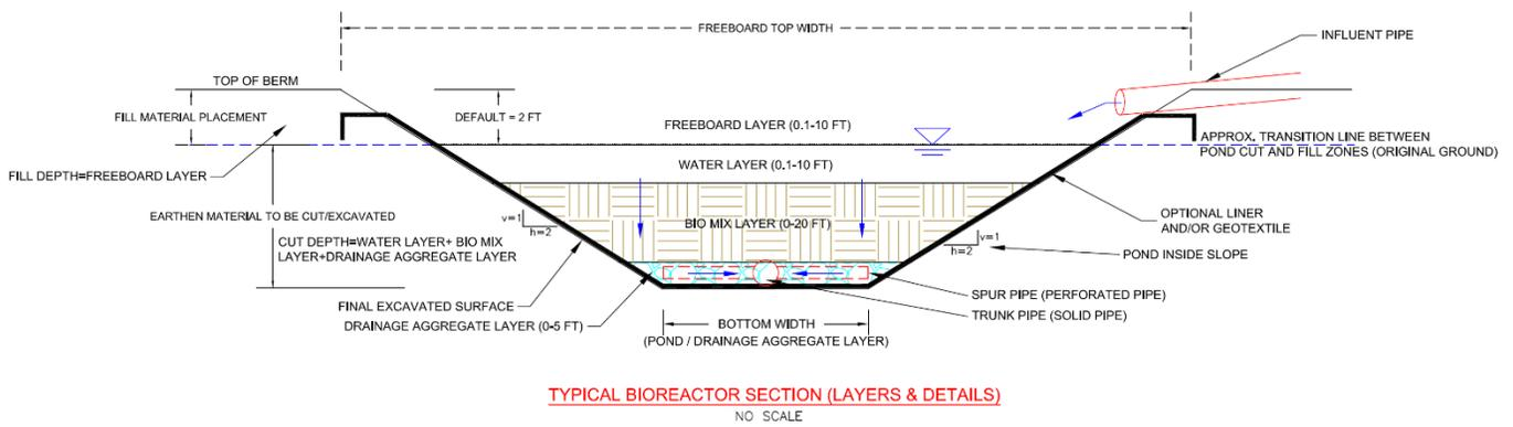
**TYPICAL BIOREACTOR SECTION (LAYERS & DETAILS)**
