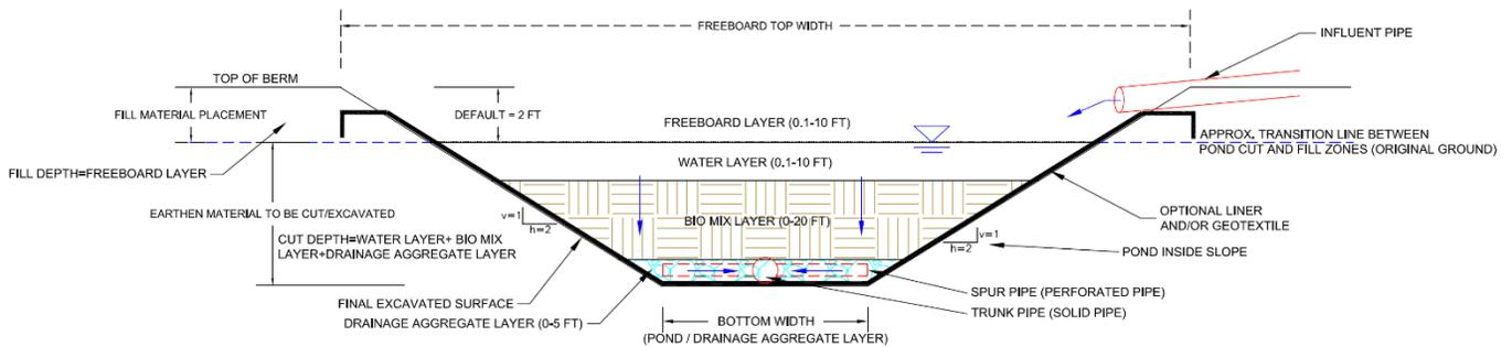
**TYPICAL BIOREACTOR SECTION (LAYERS & DETAILS)**
