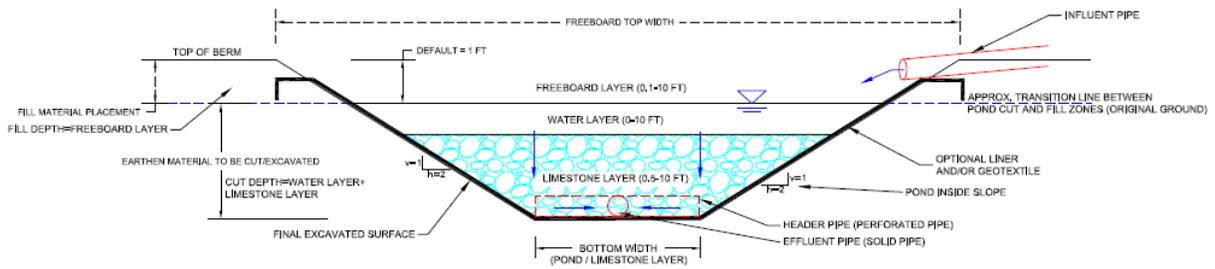
**TYPICAL LIMESTONE BED SECTION (LAYERS & DETAILS)**
